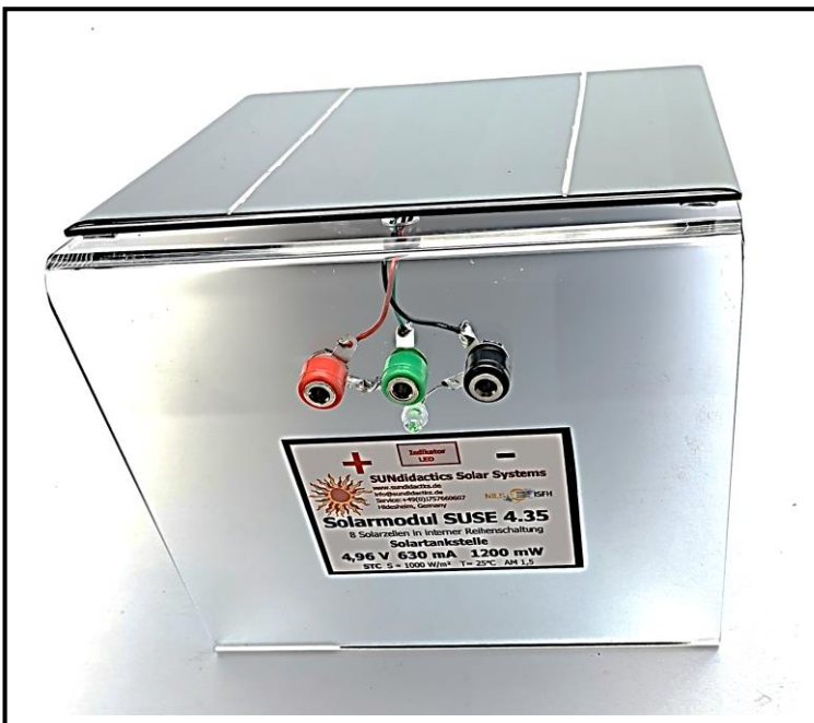
Oben: Das Solarmodul SUSE 4.35, auf der Vorderseite befinden sich die 8 Solarzellen in interner Reihenschaltung, auf der Rückseite erkennt man die 3 Buchsen rot (+), grün, und schwarz (-), darunter die grüne LED zur Betriebsanzeige.
