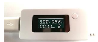
Das USB- Messgerät misst gleichzeitig die Spannung U in V (oben links), die Stromstärke in A (oben rechts) und die seit dem Start geflossene Ladung in mAh. Die Werte werden für jeden Versuch gespeichert, die 2 unten rechts ist für Exp.2
