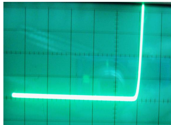
I- U- Kennlinie der IR- LED . Der Kennlinienknicke liegt bei ca. 1,1 V.
